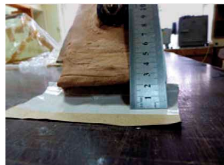
2 pav. Susitraukimo deformacijos džiūnant Fig. 2. Shrinkage deformation during drying
