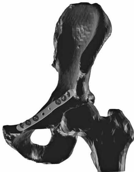
2 pav. Lūžio fiksavimas plokštele, naudojant XXXOOOXX varžtų išdėstymo būdą
