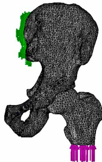
4 pav. Modelis, suskirstytas baigtiniais elementais, įtvirtintas ir apkrautas Fig. 4. Model divided into finite elements, fixed geometry and external load applied
