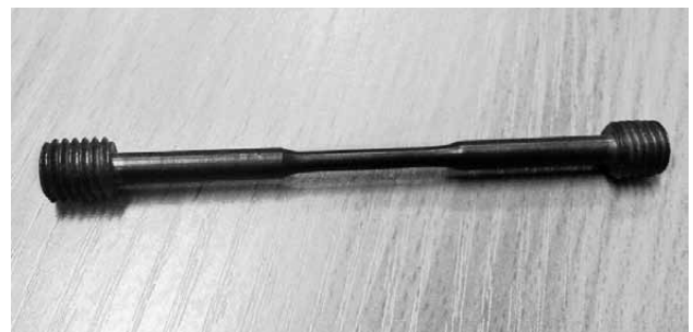
Рис. 1. Образец для механических испытаний на растяжение
