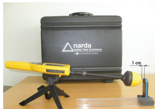
2 pav. Elektromagnetinių laukų matavimo schema Fig. 2. Scheme for measuring the electromagnetic field
